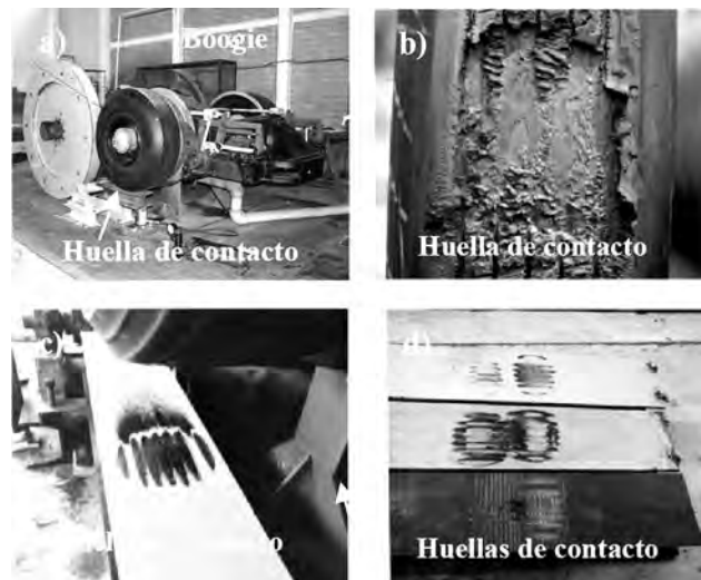
Figura 4. Huellas de contacto tomadas en el boogie con carga; a) boogie (Metro), b) huellas de contacto estática por neumático bloqueado y deslizamiento, c) huella de contacto dinámica por rodadura y d) huellas de contacto sobre diferentes acabados superficiales en las pistas metálicas [1].
